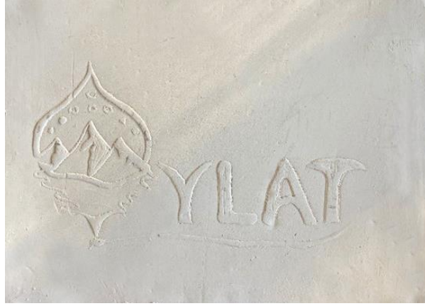
Şekil 10. Tasarımın kurutulmuş rötuşa hazır seramik ham ürün hali
